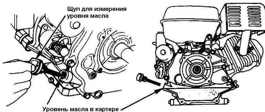
Рисунок 2 – Уровень масла в картере двигателя
