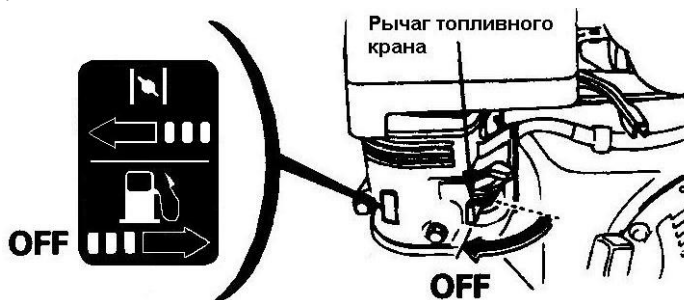
Рисунок 12 – Рычаг топливного крана в положении "OFF" ("Выключено")
