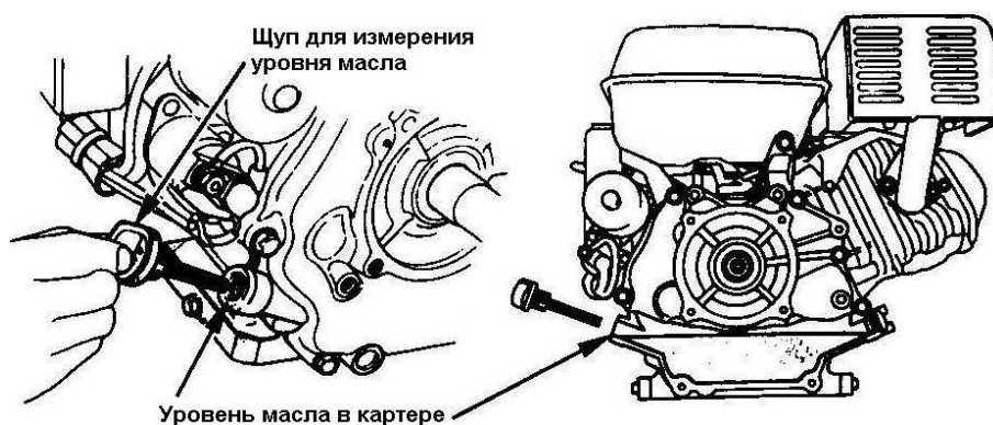
Рисунок 2 – Уровень масла в картере двигателя
