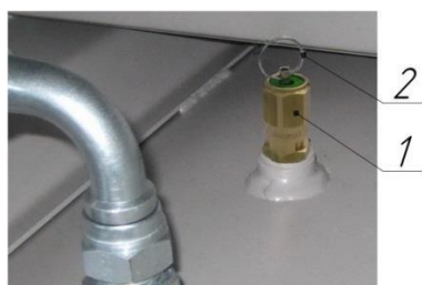
Рисунок 8 – Клапан предохранительный пружинного типа
